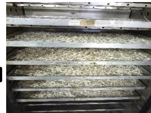
Setelah difresto, tulang ikan dikeringkan dalam cabinet dryer
