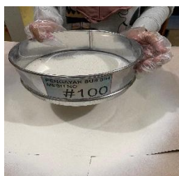
Setelah digiling, diayak dengan ayakan 100 mesh
