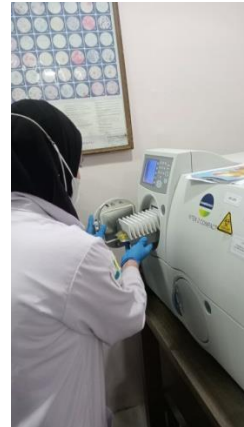
Kartu diinkubasi dan dibaca secara otomatis oleh sistem Vitek 2
