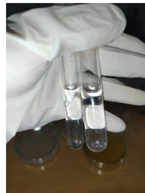
Penyetaraan kekeruhan suspensi bakteri dengan larutan Mc Farland
