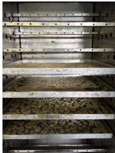
Dikeringkan selama 8 jam dengan suhu 60°C
