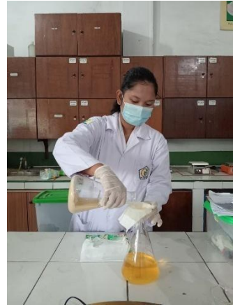
Melakukan Penyaringan Pada Sampel Jengkol Setelah Di Maserasi Selama 72jam
