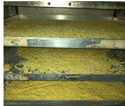
Mengeringkan jawawut dengan Cabinetdryer pada suhu 80° C selama 8 jam
