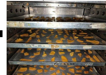
Labu kuning dikeringkan dengan Cabinetdryer dengan suhu 80° C selama 12 jam
