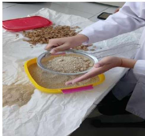
Proses penyaringan serbuk menggunakan ayakan 40 mes
