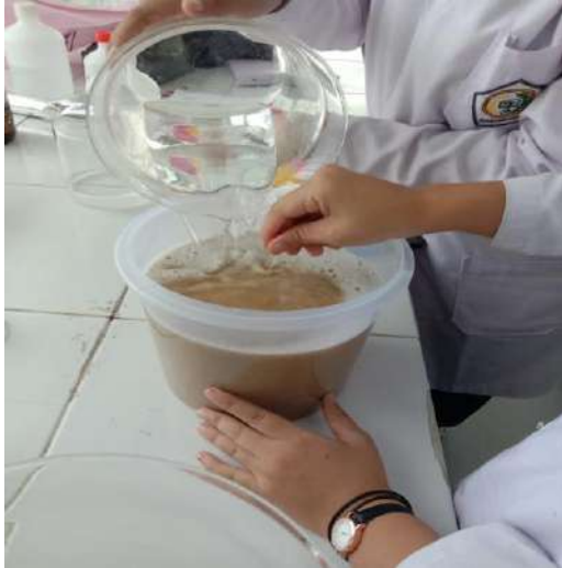
Proses perendaman serbuk kunyit putih dengan etanol 70%
