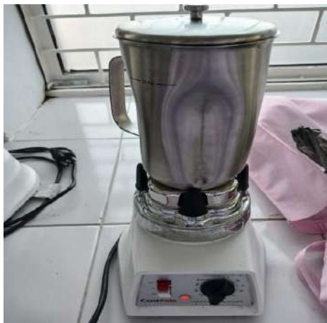
Proses penghalusan kunyit putih menjadi serbuk menggunakan blender laboratorium
