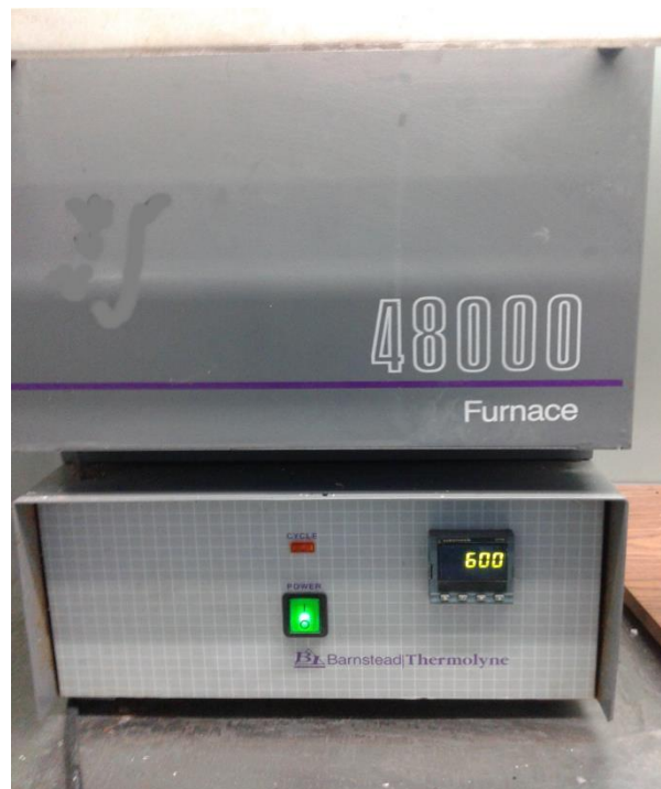
Gambar 5 Pengabuan selama 3- 4 jam suhu 600 °C
