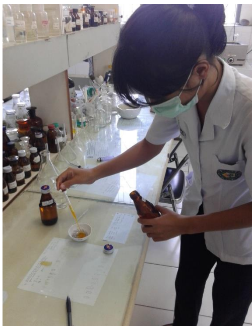
Gambar 11 Penambahan Larutan Kurkumin 1% dalam metanol
