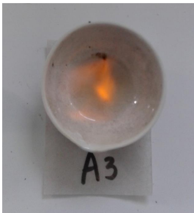
Gambar 17 Uji abu sampel pada Metode Nyala Api Tidak terjadi nyala api hijau menunjukkan Hasil Negatif (-)
