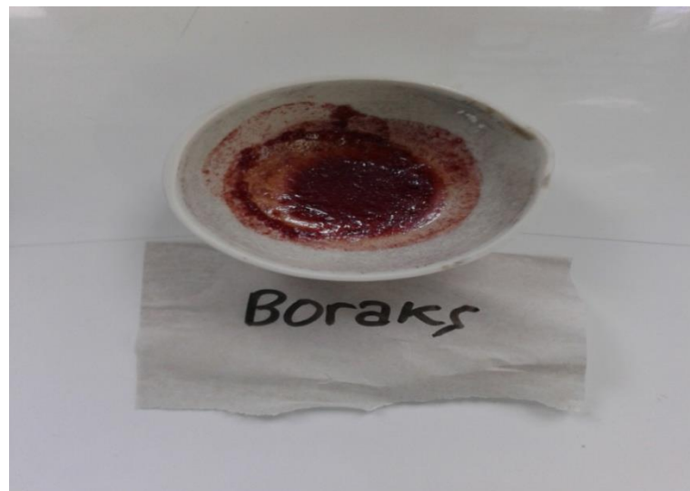
Gambar 9 Pembandingan II ( Boraks) Pada Metode Larutan Kurkumin Menunjukkan warna cemerlang
