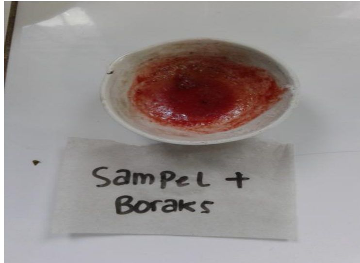
Gambar 8 Pembandingan I ( Sampel + Boraks) Pada Metode Larutan Kurkumin Menunjukkan warna merah cemerlang
