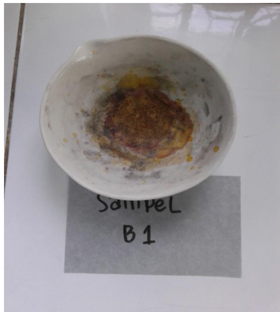
Gambar 13 Hasil pengeringan abu sampel pada Metode Larutan Kurkumin berwarna kuning menunjukkan hasil negatif (-)
