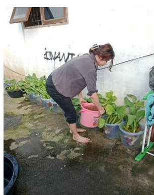
Gambar 7. menghomogenkan air limbah yang akan dibagi setiap wadah
