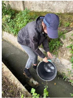
Gambar 6. pengambilan limbah cair untuk fitoremediasi
