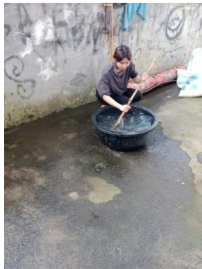
Gambar 7. menghomogenkan air limbah yang akan dibagi setiap wadah
