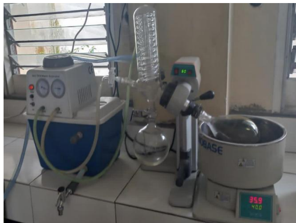
Proses pengentalan kunyit putih pakai alat rotary evaporator
