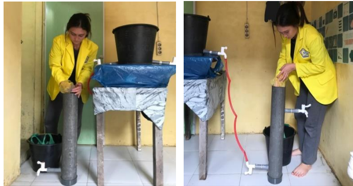
Gambar 3. Penyusunan Media Filtrasi Up Flow dan Down Flow
