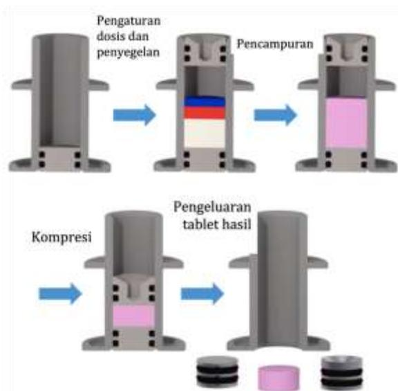
**Gambar 7.11.** Alur kompresi tablet *single-press*
