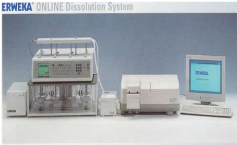
**Gambar 11.5.** Alat uji disolusi tablet (Erweka DT 708)
