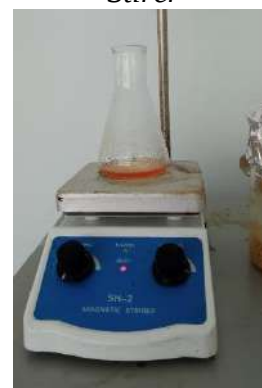
Media Dihomogenkan Di Magnetic Stirrer
