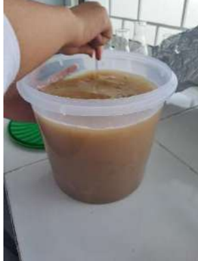
Proses Maserasi Direndam Dengan 75% bagian Dari Etanol Selama 5 Hari
