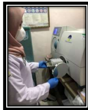
Memasukkan cassette ke Vitek 2 compact
