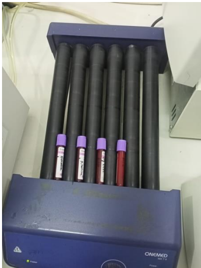
Menghomogenkan sampel dengan rotator
