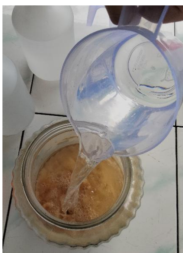
Proses maserasi direndam dengan pelarut Etanol 50% selama 5 hari
