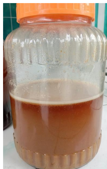
Proses maserasi direndam dengan pelarut Etanol 50% selama 5 hari
