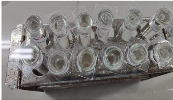
Sampel pada tabung reaksi ditutup dengan deck glass
