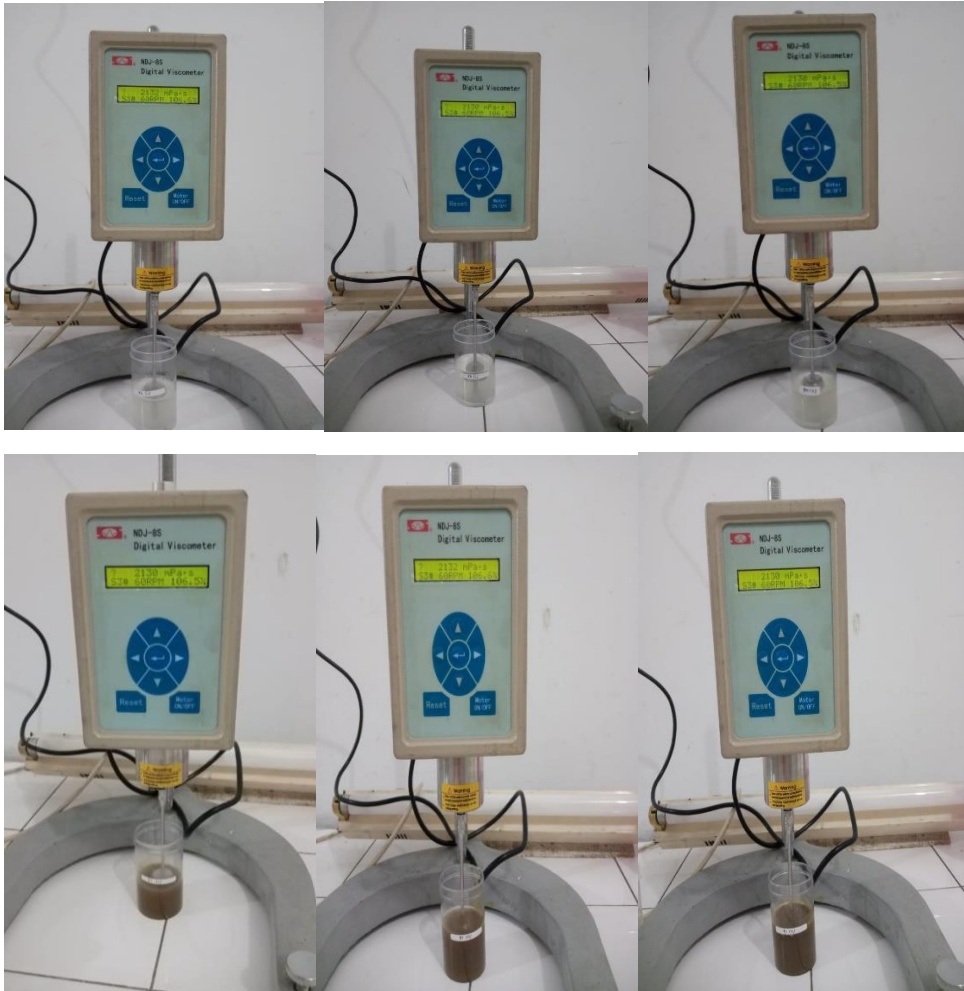
Gambar 1. Hasil Uji Viskositas Sediaan Gel F0 Dan F1 Dengan 3 Kali Pengulangan
