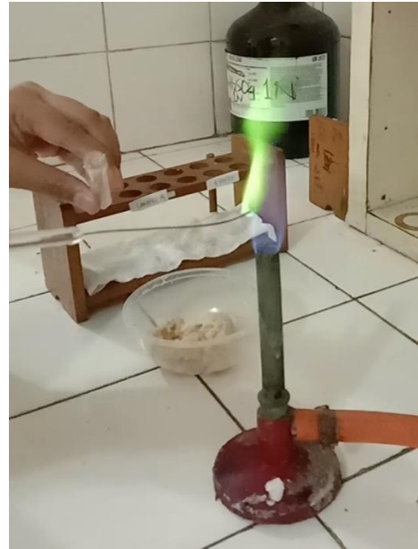
Uji Nyala Api Terjadi Nyala Api Hijau
