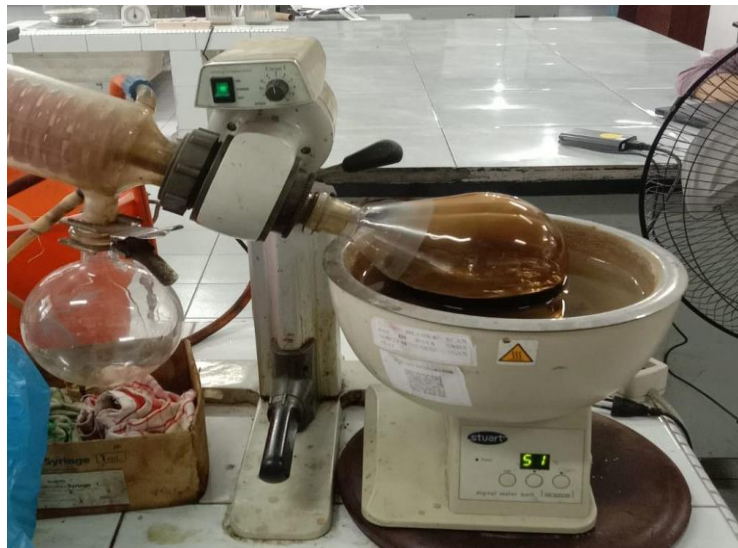
Proses Pengentalan Ekstrak Menggunakan Rotary Evaporator
