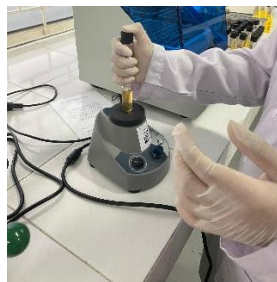
Pemisahan endapan sel bakteri dari supernatan hasil sentrifugasi dan pencucian dengan larutan PBS
