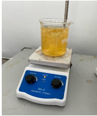
Menghomogenkan media Dengan magnetic stirrer
