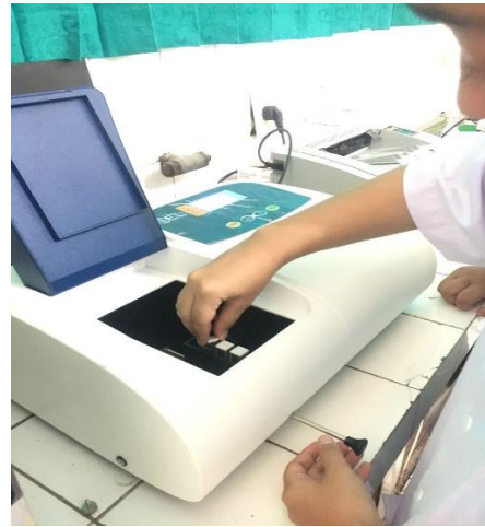
Pengujian Metode DPPH dengan angka serapan pada Spektrofotometer Vis
