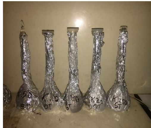
Pembuatan larutan dengan variasi konsentrasi dari 50 ppm, 100 ppm, 150 ppm, 200 ppm dan 250 ppm.
