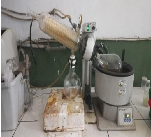
Proses rotary evaporator pada 40°C hingga menghasilkan ekstrak kental
