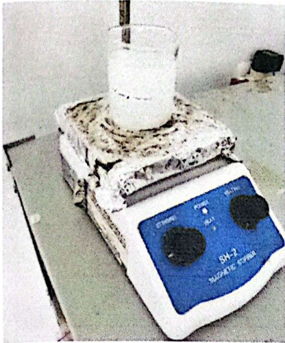
Proses Homogen Mouthwash Menggunakan magnetic stirrer
