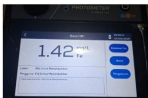
Gambar 7. Pemeriksaan sampel air menggunakan photometer ZE-200
