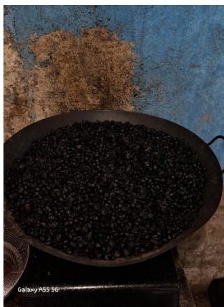
Gambar 4. Proses aktivasi arang menggunakan NaCl
