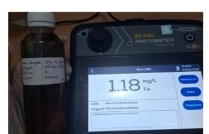
Gambar 7. Pemeriksaan sampel air menggunakan photometer ZE-200
