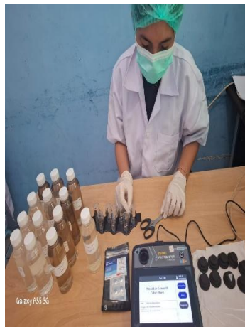
Gambar 7. Pemeriksaan sampel air menggunakan photometer ZE-200
