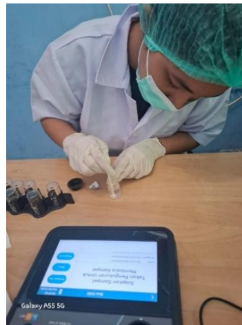
Gambar 7. Pemeriksaan sampel air menggunakan photometer ZE-200
