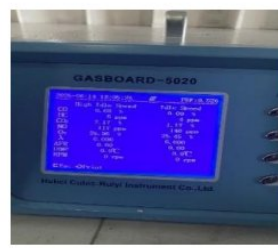
Gambar 6. Tampilan hasil pengukuran emisi pada layar Gas Analyzer
