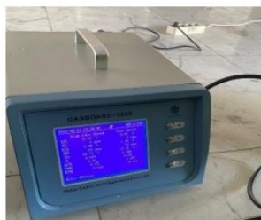
Gambar 6. Tampilan hasil pengukuran emisi pada layar Gas Analyzer
