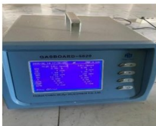
Gambar 6. Tampilan hasil pengukuran emisi pada layar Gas Analyzer
