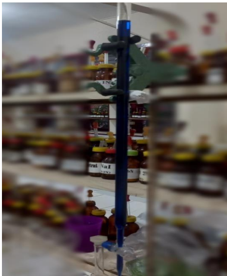
Gambar 8 Larutan 2,6 Diklorofenol Indofenol dalam buret
