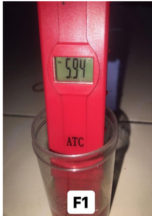
Lampiran 10. Gambar Hasil Pengukuran pH Sediaan Masker Peel Off
