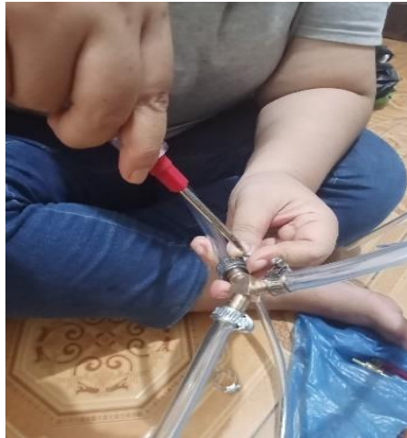
Pemasangan Selang Y
