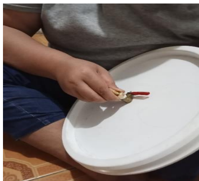
Pemasangan Keran Kompresor
