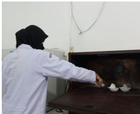
Kertas saring dimasukkan kedalam oven pada suhu 105^\circ\text{C}
