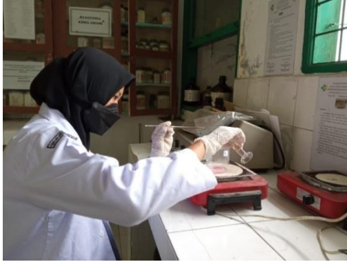
Penambahan reagen \text{H}_2\text{SO}_4 saat sampel dipanaskan hingga mendidih
