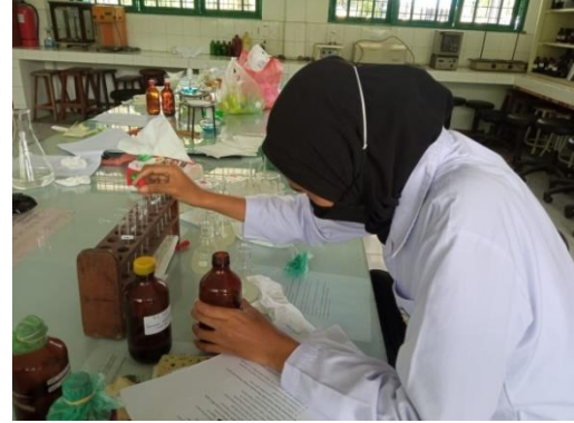
Penambahan reagen KI 6N dan reagen \text{NH}_4\text{OH} 2N untuk mendeteksi tembaga
