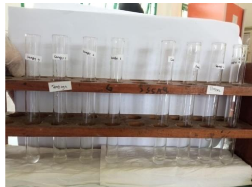
Sampel setelah ditetesi HCl untuk mendeteksi timbal dan sampel setelah ditetesi \text{NH}_4\text{OH} 2N untuk mendeteksi tembaga
