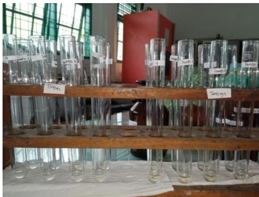
Sampel setelah ditetesi KI 10% untuk mendeteksi timbal dan sampel setelah ditetesi KI 6N untuk mendeteksi tembaga
