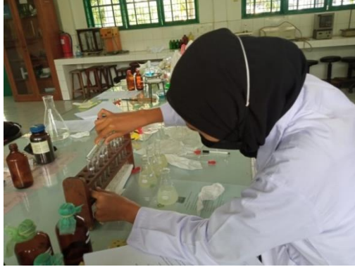
Penambahan reagen KI 10% dan reagen HCl untuk mendeteksi timbal
