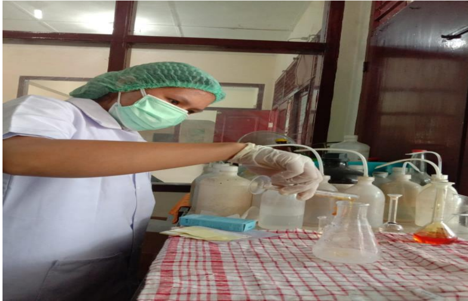
Pencampuran sampel dengan aqua regia
