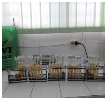
Uji Media LB yang telah di inkubasi 2x24 jam. Positif dengan terbentuknya gas dalam tabung durham
