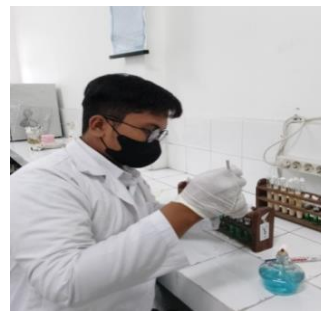
Inokulasi dari Media LB ke Media BGLB dan di inkubasi 1x24 jam 44,5°C
