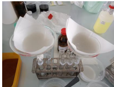
Gambar 1 : Proses preparasi sampel dimulai dari memotong bakso menjadi bagian kecil dan menimbang sampel di neraca analitik hingga penyaringan larutan sampel
