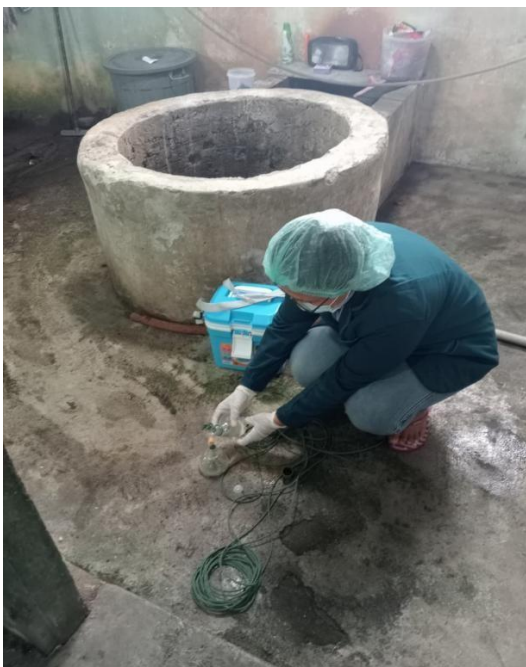
Gambar Pengukuran Cincin Sumur Gali, Bibir Sumur Gali, Lebar Lantai, dan Jarak Sumber Pencemaran
