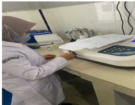
Gambar 6 Membaca Hasil pada Alat DR-7000D
