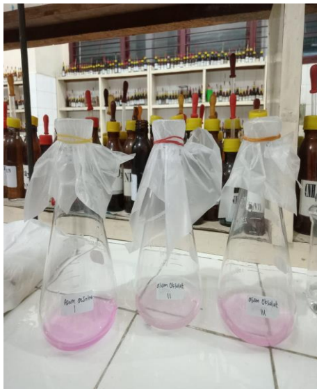
Gambar 9. Perubahan warna merah jambu pada titrasi baku.
