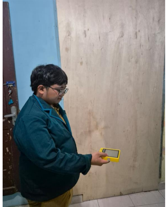
Pengukuran Kelembaban menggunakan Hygrometer
