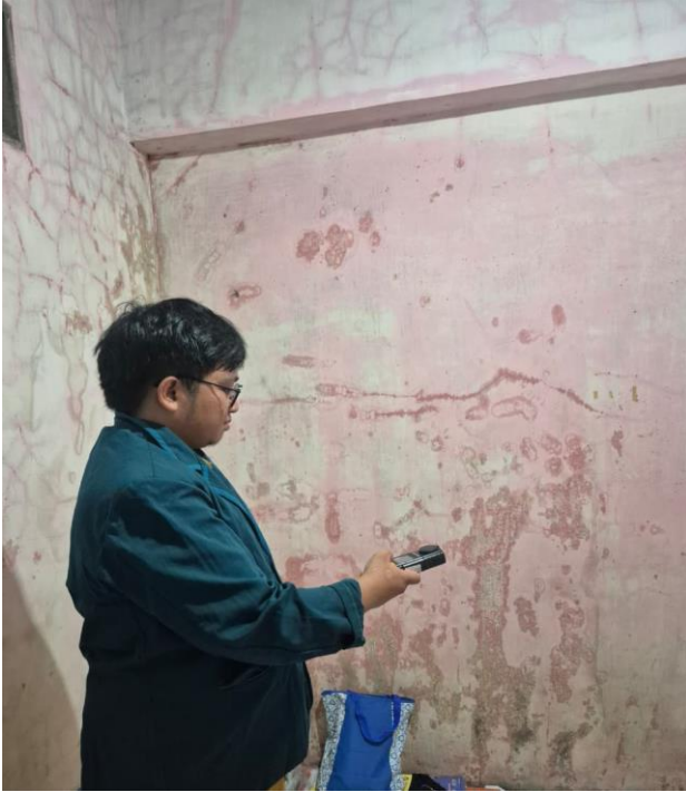
Pengukuran Pencayahaan menggunakan Lux Meter
