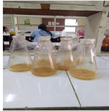
3.9 Sampel dicampur dengan HNO 3 (p) dan HCl(p)
