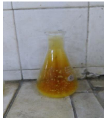
3.11 sampel yang telah dipanaskan ditambah 2ml asam nitrat (p)
