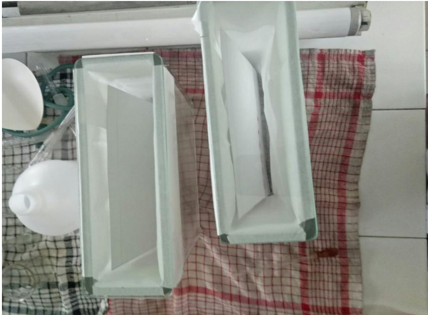
Gambar 3. Plat KLT yang sudah ditotolkan dimasukkan kedalam chamber yang telah jenuh
