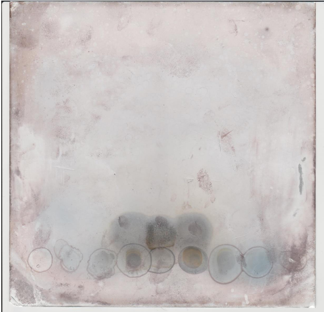
Gambar 6. Hasil Identifikasi Hidrokuinon Pada Sampel Secara Kromatografi Lapis Tipis Pada Plat 2
