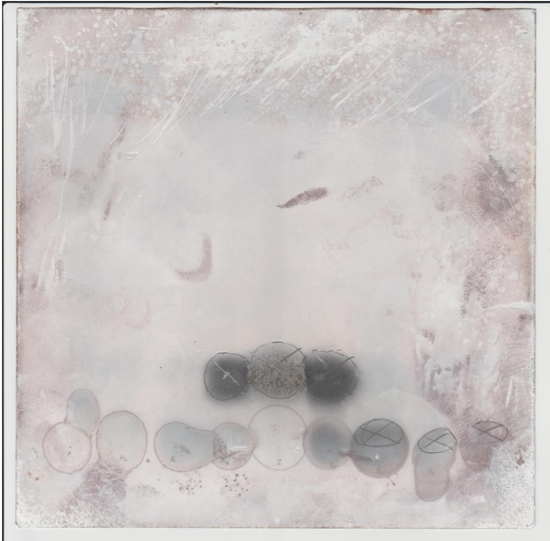
Gambar 5. Hasil Identifikasi Hidrokuinon Pada Sampel Secara Kromatografi Lapis Tipis Pada Plat 1
