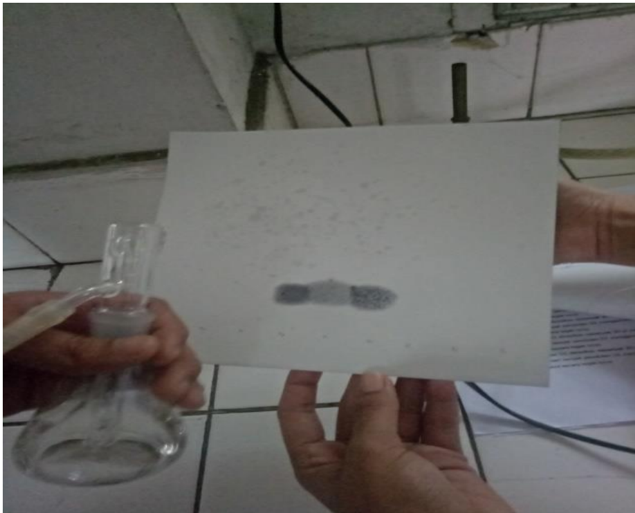
Gambar 4. Proses Penyemprotan Larutan Penampak Bercak Pada Lempeng KLT
