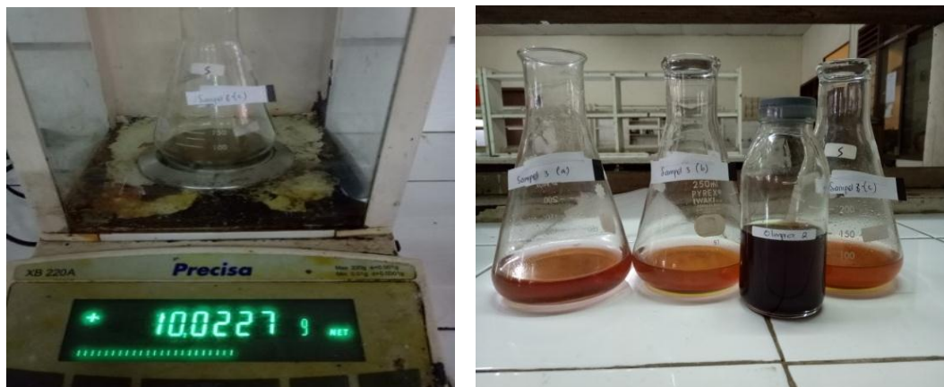
Gambar 1.10 Proses Penimbangan dan Penitrasi Sampel BW 3
