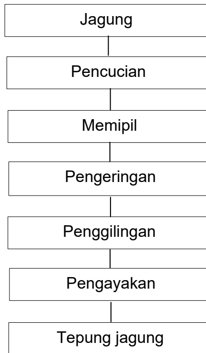
Gambar 8. Diagram Alir Proses Pembuatan Tepung Jagung
