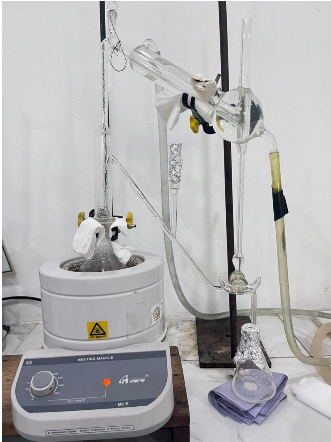
Lampiran 8. Proses Destilasi Uap Minyak Atsiri Bunga Kenanga
