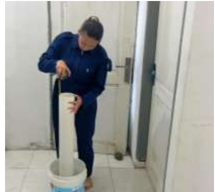
Gambar 13 – Gambar 18 Pengisian media filtrasi zeolite, ferolite dan resin pada pipa filtrasi dan mengukur ketinggian setiap media
