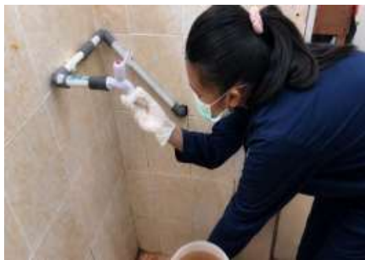
Gambar 19 dan Gambar 20 Pengambilan sampel sebelum pada filtrasi multimedia pada pipa I, pipa II dan pipa III
