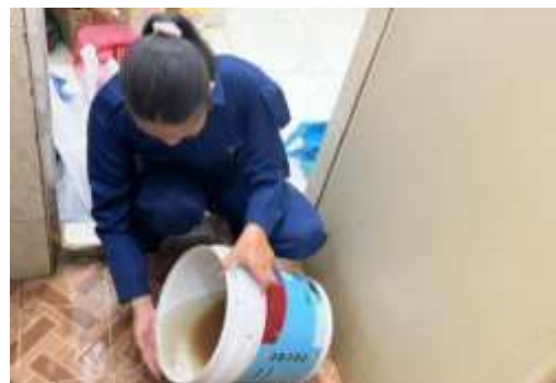
Gambar 11 dan Gambar 12 Pencucian media resin dengan air bersih
