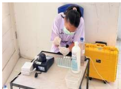
Gambar 25 dan Gambar 26 Pemeriksaan kadar besi (Fe) dan kadar mangan (Mn) sebelum dan sesudah, pada filtrasi multimedia pipa I, pipa II dan pipa III menggunakan Photometer ZE 200
