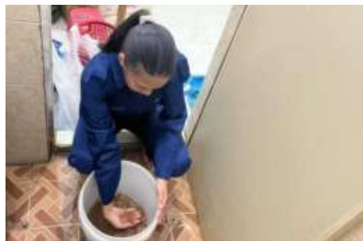
Gambar 11 dan Gambar 12 Pencucian media resin dengan air bersih
