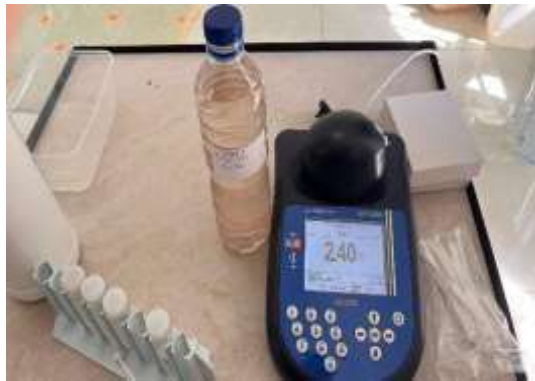
Gambar 27 Hasil pemeriksaan kadar besi (Fe) sebelum menggunakan filter multimedia
