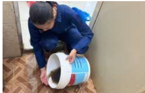
Gambar 9 dan Gambar 10 Pencucian media ferolite dengan air bersih
