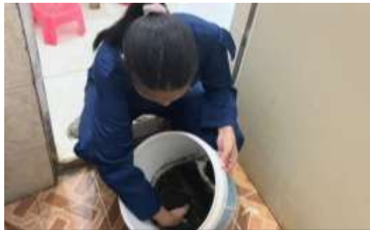
Gambar 9 dan Gambar 10 Pencucian media ferolite dengan air bersih
