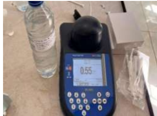
Gambar 28 Hasil pemeriksaan kadar besi (Fe) sesudah menggunakan Filter Multimedia
