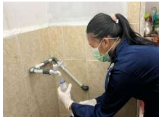
Gambar 21 dan Gambar 22 Pengambilan sampel sesudah pada filtrasi multimedia pada pipa I, pipa II dan pipa III
