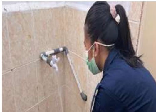
Gambar 21 dan Gambar 22 Pengambilan sampel sesudah pada filtrasi multimedia pada pipa I, pipa II dan pipa III
