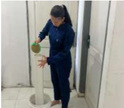
Gambar 13 – Gambar 18 Pengisian media filtrasi zeolite, ferolite dan resin pada pipa filtrasi dan mengukur ketinggian setiap media
