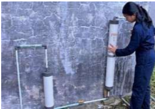
Gambar 14 dan Gambar 15 Proses pemasangan pipa filtrasi pada pipa I dengan waktu ( 5,10,15 menit )
