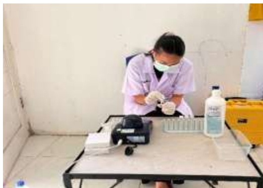
Gambar 25 dan Gambar 26 Pemeriksaan kadar besi (Fe) dan kadar mangan (Mn) sebelum dan sesudah, pada filtrasi multimedia pipa I, pipa II dan pipa III menggunakan Photometer ZE 200
