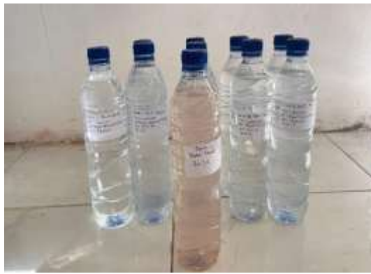
Gambar 23 Sampel air untuk pemeriksaan kadar Besi (Fe) sebelum dan sesudah menggunakan filter multimedia
