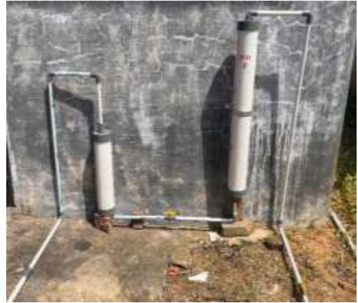
Gambar 15 dan Gambar 16 Proses pemasangan pipa filtrasi pada pipa II dengan waktu ( 5,10,15 menit )
