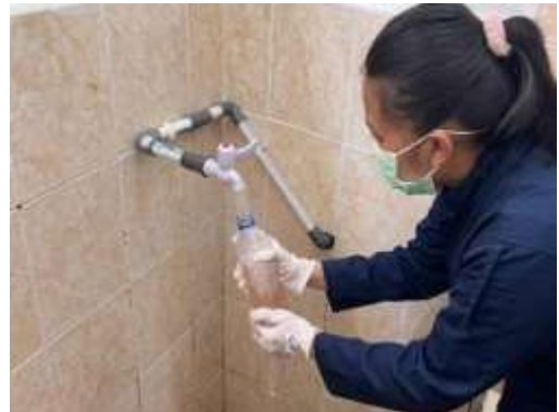
Gambar 19 dan Gambar 20 Pengambilan sampel sebelum pada filtrasi multimedia pada pipa I, pipa II dan pipa III
