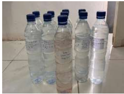
Gambar 24 Sampel air untuk pemeriksaan kadar Mangan (Mn) sebelum dan sesudah menggunakan filter multimedia
