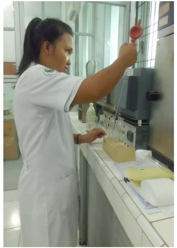
Gambar 7 : 5 ml destilat dimasukkan ke dalam tabung reaksi lalu ditambahkan 5 ml Asam Kromatopat 0,5% dalam Asam Sulfat 60%
