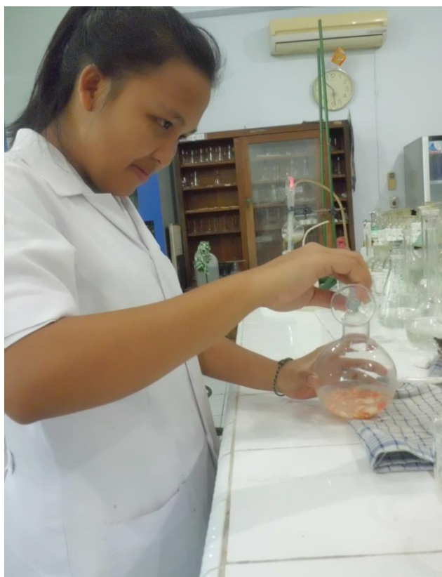
Gambar 4: Pemberian 5 ml Asam Fosfat 10% ke dalam labu Destilasi
