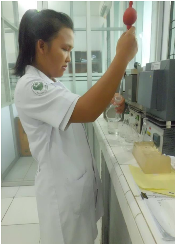
Gambar 7 : 5 ml destilat dimasukkan ke dalam tabung reaksi lalu ditambahkan 5 ml Asam Kromatopat 0,5% dalam Asam Sulfat 60%
